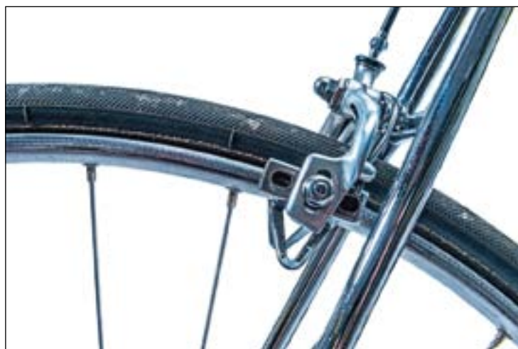
Gebremst wird bei den Profis von heute noch wie vor 30 Jahren. Doch schon bald werden Scheibenbremsen die Felgenbremsen ersetzen. Deren Vorteil: gleichbleibende Leistung im Trockenen und bei Nässe.
